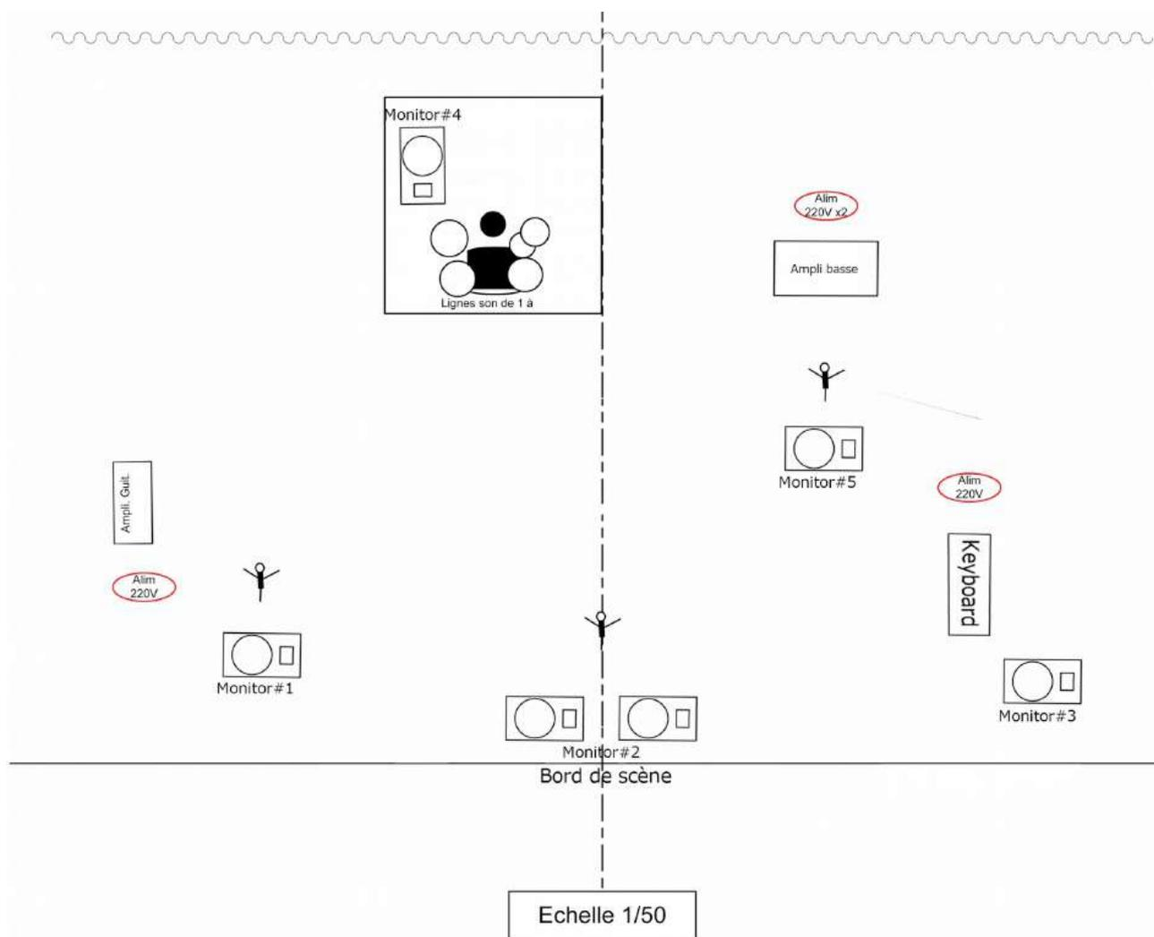
**Alimentation électrique 220 V, 50 Hz, prise CE, circuit de mise à la terre correct**
